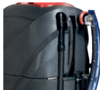
Вградена система за окачване на миячното устройство за лесно преместване на машината в тесни участъци
