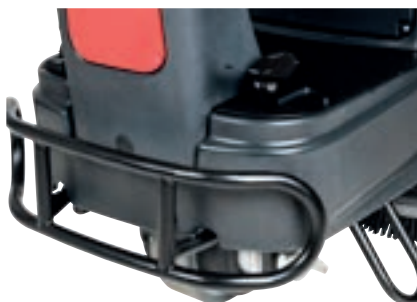
Предната броня защитава машината
